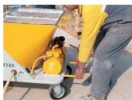
Système encastré d'anses de transport de chaque côté de la machine, ce qui permet de la transporter par 2 personnes.
